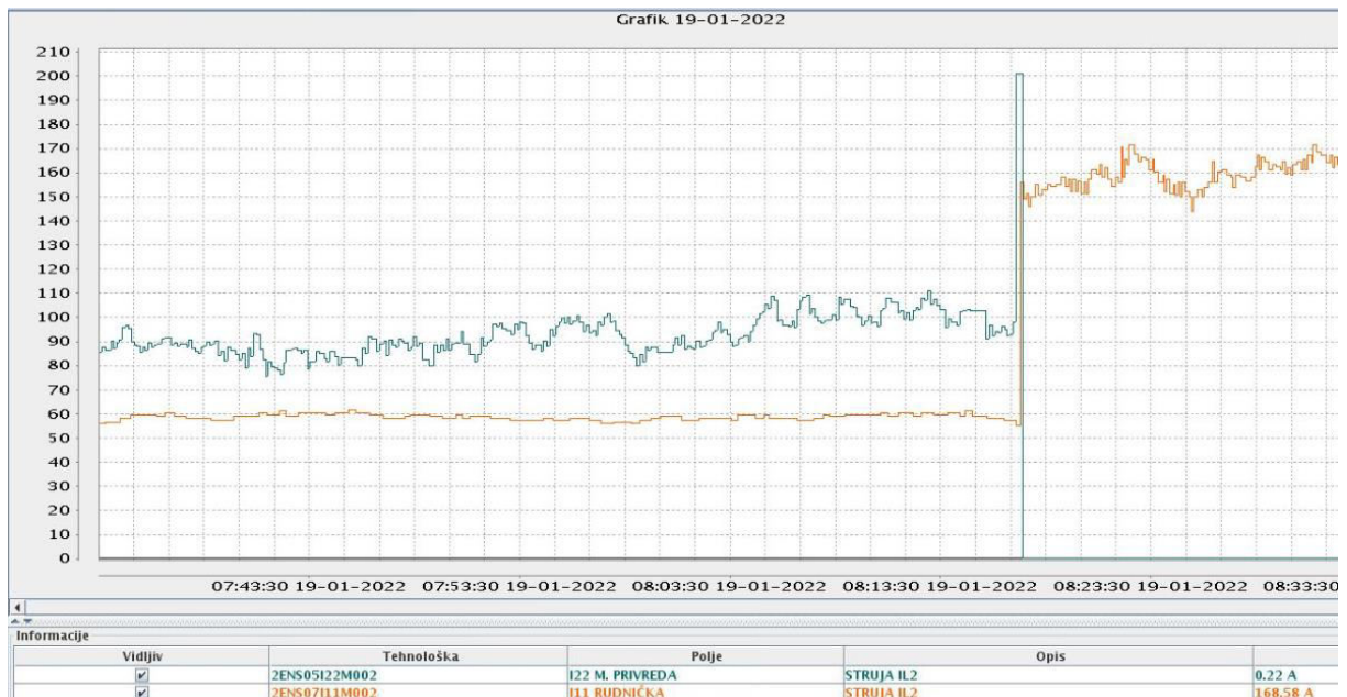
Slika 2 – Povećanja vrednosti struja paralelovanjem prvog para izvoda
